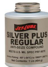
SILVER PLUS REGULAR es una mezcla de uso pesado de lubricantes de aluminio, cobre y grafito en una base de grasa de petróleo. Es un anti-adherente suave, no secante, especialmente formulado para trabajar con roscas de aluminio, acero al carbón, hierro negro y de corte rugoso.
